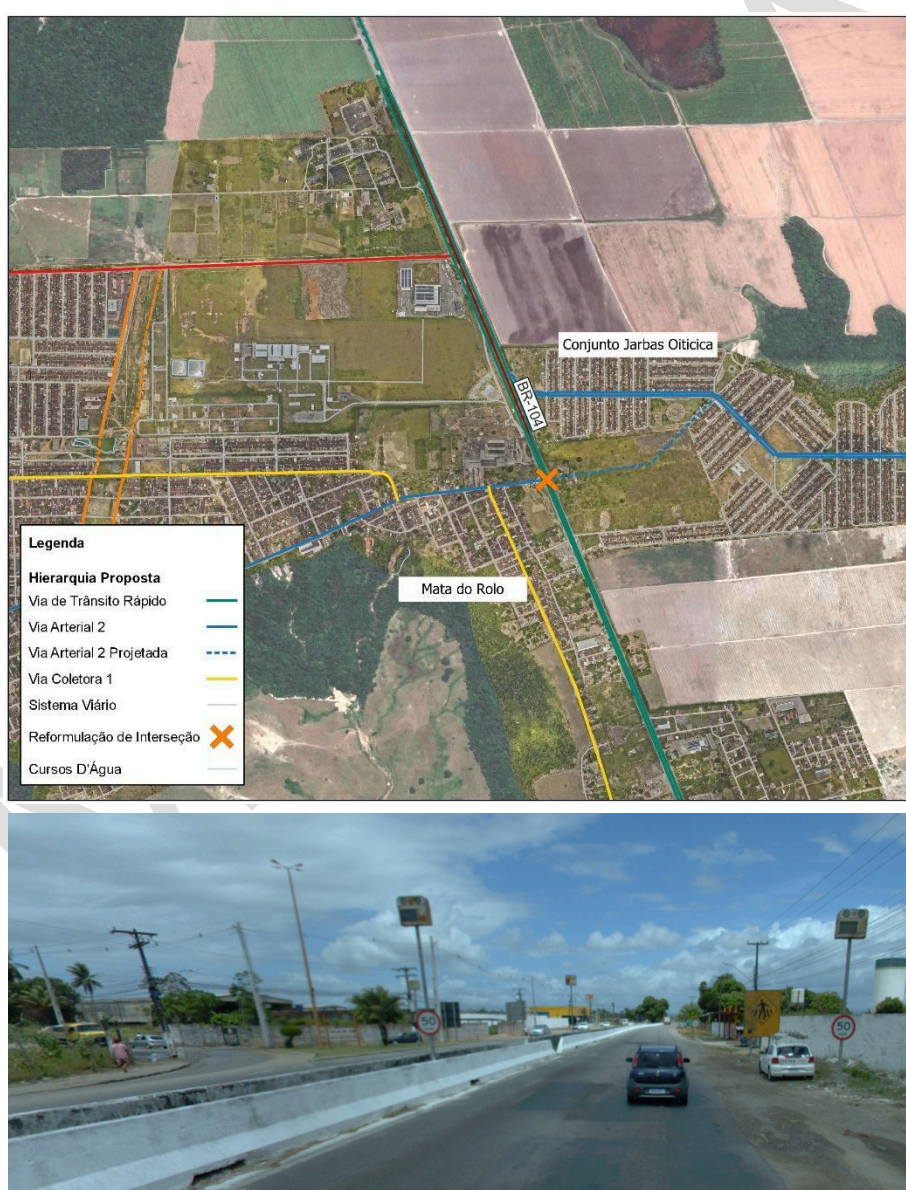
Figura 6-18: Proposta de interseção em desnível com rotatória e trincheira em Rio Largo
